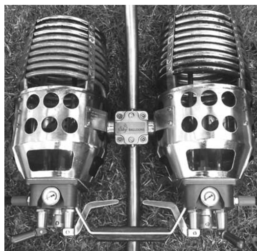
Figure 25 : Brûleur de 3ème génération (monobloc, cardan central)
