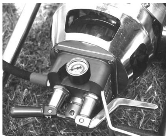
Figure 26 : Détail sur le "monobloc" (disparition de la tuyauterie entre les vannes)
